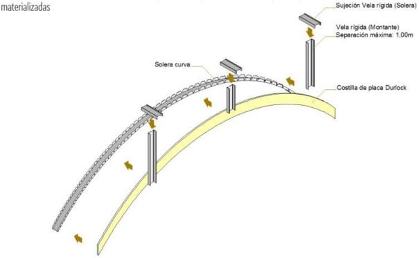
Por debajo de las vigas maestras, y en forma perpendicular a ellas, se colocarán los perfiles Montante con una separación determinada en función del radio de curvatura, según la siguiente tabla:
