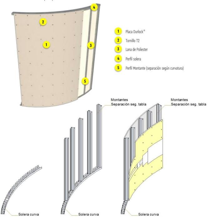
Utilizando las Soleras como guía, se colocarán los Montantes con una separación determinada en función del radio de curvatura de la pared, según la siguiente tabla.
